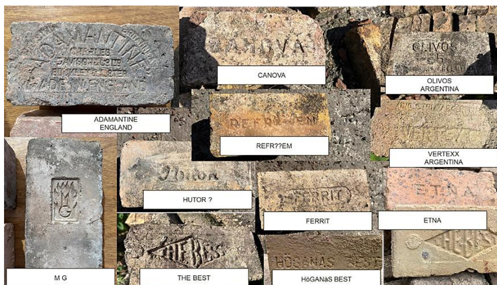
Figura 7. Ladrillos refractarios de origen extranjero y local encontrados en el Ingenio San Pablo. Fuente: fotografías y elaboración propia.
