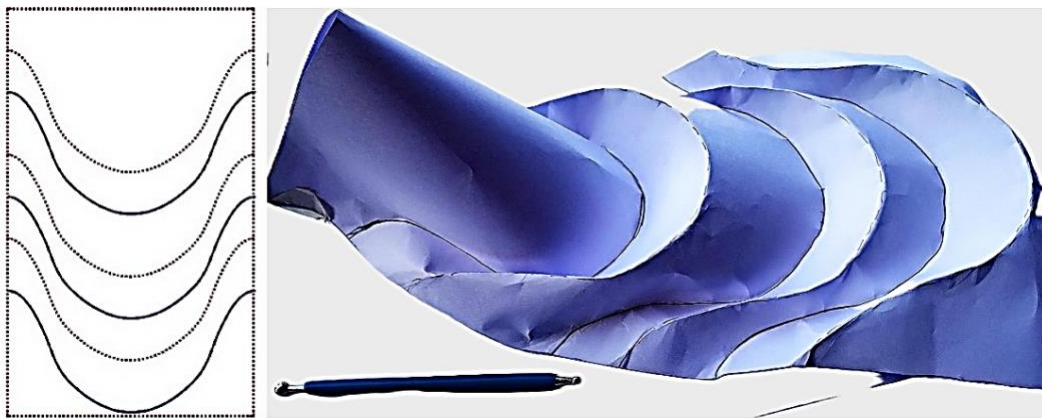
Figura 6. Tipo de Diagrama de Plegado Curvo. (Parábola cónica)
