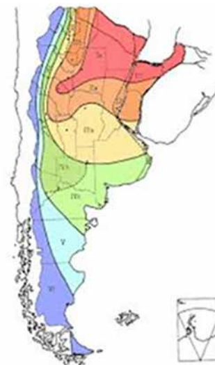
Imagen 3. Regiones según Norma IRAM Clasificación ambiental: i Muy cálido/ii Cálido/iii Templado cálido/iv Templado frío/v Frío/vi Muy frío
