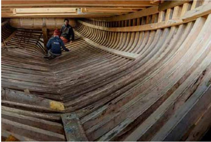
Imagen 2 Construcción de embarcación maderera
