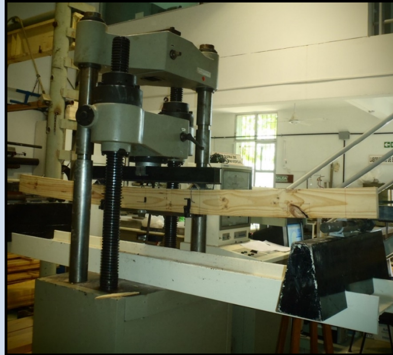
Ensayos estáticos para determinar propiedades mecánicas
