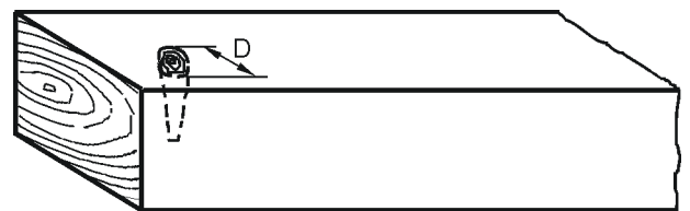
Figura 1 – Medición de un nudo
