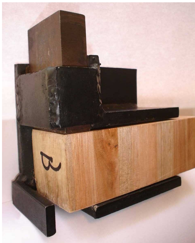
Figura 3 – Ejemplo de dispositivo de sujeción de la probeta para el ensayo de cizallamiento
